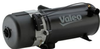
La serie Thermo E+ è la migliore in termini di consumo e funziona in modo efficiente anche a temperature basse come -40 °C. Sono disponibili a 12V o 24V e anche con alimentazione singola o doppia sistema di linea. La versione da 12 kW è stata concepita come riscaldatore ausiliario per mini, midi ed e-bus. È uno dei più corti e più leggeri della sua categoria.
