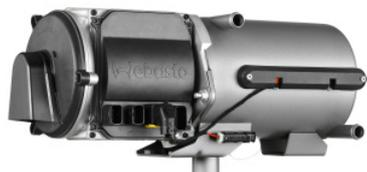
I riscaldatori Thermo Top Pro 120/150 sono dotati di un concetto di bruciatore innovativo e di un sistema intelligente di diagnosi e sicurezza. I sensori controllano la temperatura dei gas di scarico e del refrigerante e trasmettono continuamente i valori alla centralina. Una delle nuove caratteristiche di questa classe di prestazioni è la regolazione automatica dell'altitudine.
